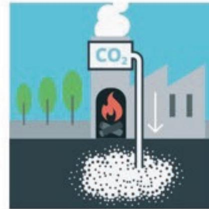
**CO<sub>2</sub> am Kamin abscheiden (BECCS):** Pflanzen wandeln CO<sub>2</sub> in Biomasse um, die beim Verbrennen Energie liefert. Das dabei wieder freigesetzte CO<sub>2</sub> wird aufgefangen und unterirdisch eingelagert.
